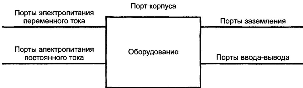
Рисунок 1 — Примеры портов оборудования
