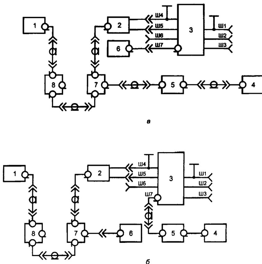
а — схема измерения напряжения на входе V-образного эквивалента сети;
