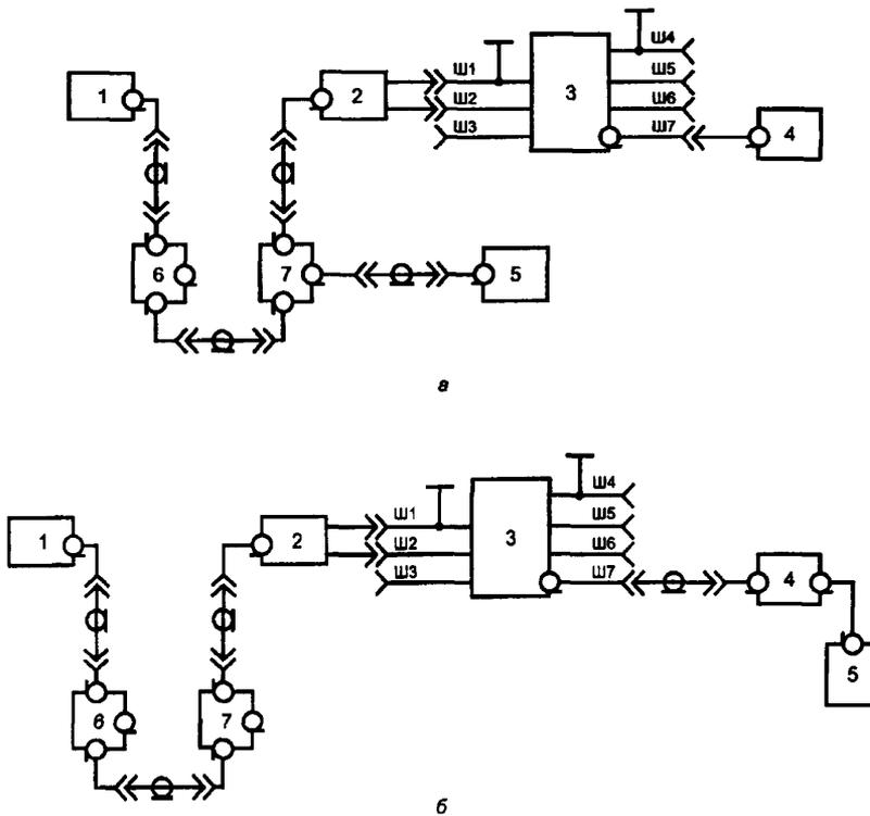
а — схема измерения образцового синусоидального напряжения  $U_1$ ,
