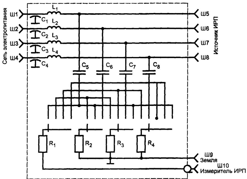
$C_1 - C_4 = 0,50 \text{ мкФ}; C_5 - C_8 = 0,1 \text{ мкФ};$
