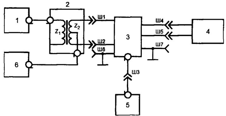
1 — селективный микровольтметр; 2 — симметрирующий трансформатор ( $Z_1 = 50$  Ом,  $Z_2 = 200$  Ом); 3 — Т-образный эквивалент сети; 4 — эквивалент линии связи; 5 — эквивалент нагрузки (50 Ом); 6 — генератор синусоидальных сигналов; Ш1, Ш2 — разъемы «ИСТОЧНИК ИРП»; Ш3 — разъем «ИЗМЕРИТЕЛЬ ИРП»; Ш4, Ш5 — разъемы «ЛИНИЯ СВЯЗИ»; Ш6, Ш7 — разъемы «ЗЕМЛЯ»
