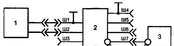
Рисунок 13 — Схема проверки входного полного сопротивления V-образного эквивалента сети без прохождения тока на частотах до 150 кГц
