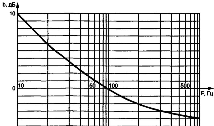
$b$  — значение импульсной характеристики;  $F$  — частота повторения импульсов
