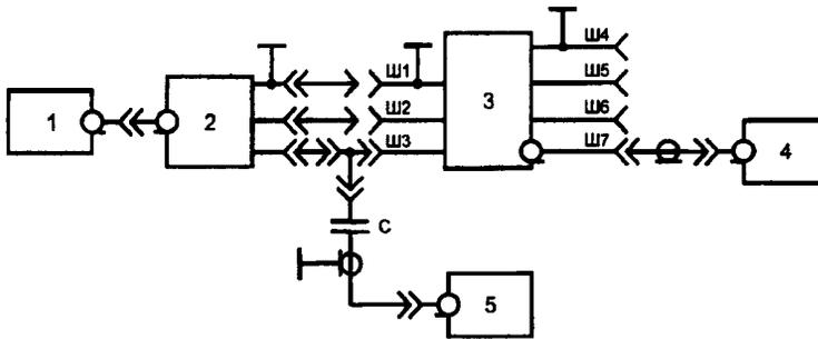
1 — согласованная нагрузка; 2 — испытуемый измеритель ИРП; 3 — V-образный эквивалент сети типов 1, 2, 4, 5; 4 — дополнительный измеритель ИРП; 5 — генератор синусоидальных сигналов;  $C = 0,1$  мкФ  $\pm 20$  % — разделительный конденсатор; Ш1, Ш4 — разъемы «ЗЕМЛЯ»; Ш2, Ш3 — разъемы «ИСТОЧНИК ИРП»; Ш5, Ш6 — разъемы «СЕТЬ ЭЛЕКТРОПИТАНИЯ»; Ш7 — разъем «ИЗМЕРИТЕЛЬ ИРП»
