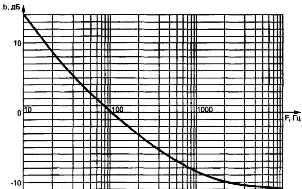
$b$  — значение импульсной характеристики;  $F$  — частота повторения импульсов
