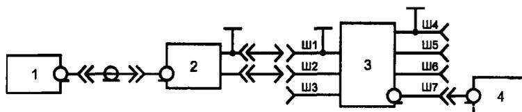
1 — измеритель полного сопротивления; 2 — переход; 3 — эквивалент сети; 4 — эквивалент нагрузки; Ш1, Ш4 — разъемы «ЗЕМЛЯ»; Ш2, Ш3 — разъемы «ИСТОЧНИК ИРП»; Ш5, Ш6 — разъемы «СЕТЬ ЭЛЕКТРОПИТАНИЯ»; Ш7 — разъем «ИЗМЕРИТЕЛЬ ИРП»
