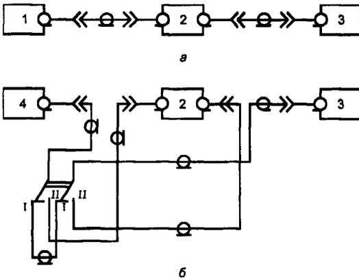
а — схема настройки генератора на частоту настройки режекторного фильтра;
