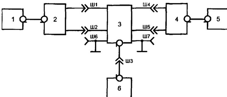
1 — генератор синусоидальных сигналов; 2, 4 — симметрирующие трансформаторы ( $Z_1 = 50$  Ом,  $Z_2 = 200$  Ом); 3 — Т-образный эквивалент сети; 5 — селективный микровольтметр; 6 — эквивалент нагрузки (50 Ом); Ш1, Ш2 — разъемы «ИСТОЧНИК ИРП»; Ш3 — разъем «ИЗМЕРИТЕЛЬ ИРП»; Ш4, Ш5 — разъемы «ЛИНИЯ СВЯЗИ»; Ш6, Ш7 — разъемы «ЗЕМЛЯ»
