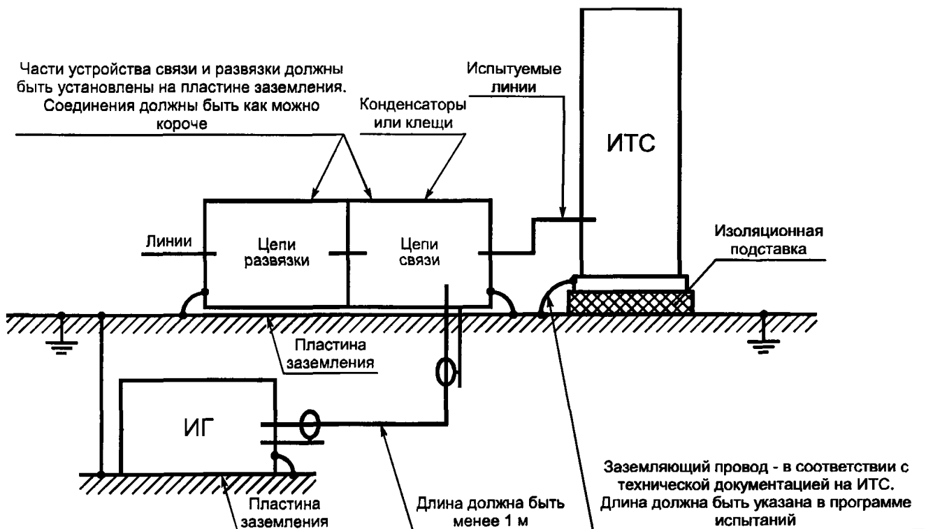
Рисунок 6 — Схема испытаний на устойчивость к НИП
