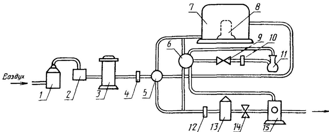
1—осушитель; 2—фильтр поглотительный; 3—озонатор; 4, 10, 12—ротаметр; 5—распределительный кран; 6—кран системы отбора проб; 7—камера для испытаний; 8—ксеноновая лампа со светофильтром (только в установке для испытаний на термосветоозоностойкость); 9, 14—регулирующий вентиль; 11—колба для отбора проб; 13—камера разложения озона; 15—вакуумный насос
