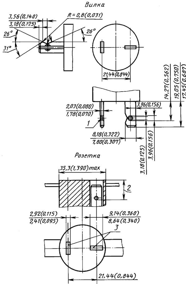
1 — отверстие факультативно; 2 — до конца выступа (при его наличии) 14,27 мм (0,562 дюйма) max; 3 — два паза с одинаковыми размерами
