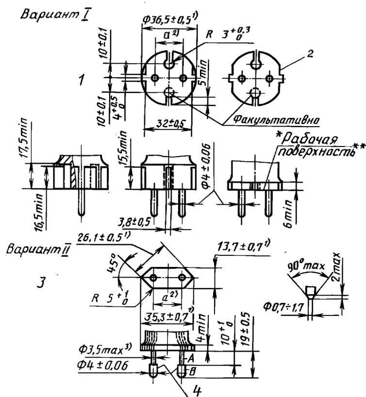
1 — вариант I, круглая вилка; 2 — вариант круглой вилки; 3 — вариант II, плоская вилка; 4 — слегка закругленные кромки A — изоляционная трубка, обязательная только для плоских вилок; B — металлический штифт.
