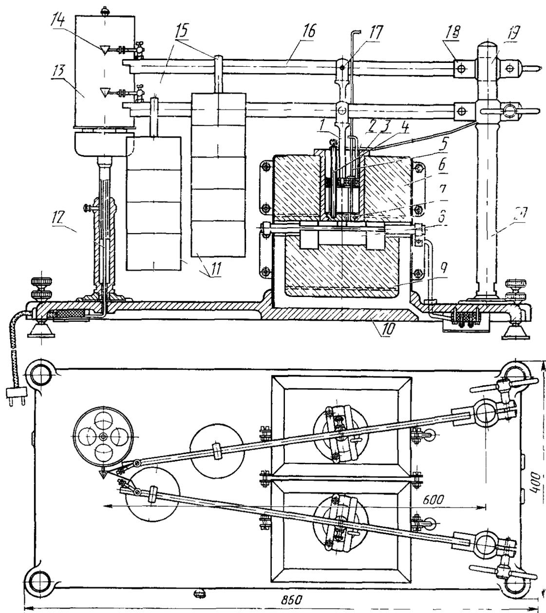
1—штемпель; 2—прижимная планка; 3—стакан; 4—трубка для термомпары; 5—пластометр; 6—верхний кирпич; 7—дно стакана; 8—нагреватель; 9—нижний кирпич; 10—плита; 11—груз; 12—стойка барабана; 13—барабан с часовым механизмом; 14—перо; 15—подвеска груза; 16—рычаг; 17—шарнирный валок; 18—шарнирный валок; 19—муфта для крепления рычага; 20—стойка; 21—установочный винт
