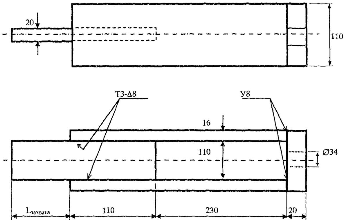
Рис. Б.3. Приспособление для испытания на статический отрыв
