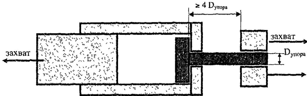
Рис. Б.2. Схема испытаний на статический отрыв
