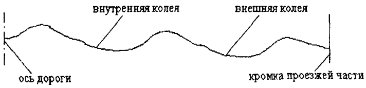
Рис. 3. Виды колеи по расположению в пределах полосы движения
