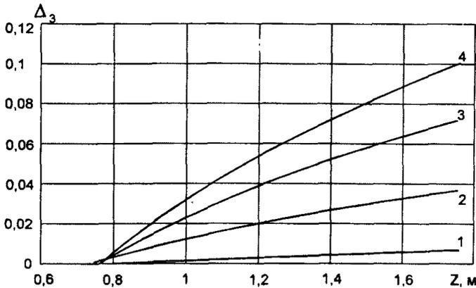
Рис.1. Графики для определения поправки на влияние суммарной толщины стабильных слоев дорожной одежды: 1 – для исходной относительной влажности  $0,75 W_t$ ; 2 – то же,  $0,8 W_t$ ; 3 – то же,  $0,85 W_t$ ; 4 – то же,  $0,9 W_t$ . Исходная влажность определяется первым слагаемым в формуле (1)
