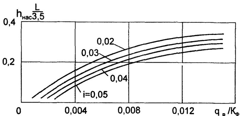
Рис. 5.2. Расчет дренающего слоя из крупных песков с коэффициентом фильтрации более 10 м/сут.  $L$  – см. рис. 5.1;  $i$  – поперечный уклон низа дренающего слоя;  $K_\phi$  – коэффициент фильтрации, м/сут
