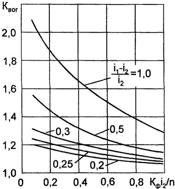
Рис. 5.3 Номограмма для определения коэффициента  $K_{\text{вог}}$  увеличения объема воды в дренирующем слое в местах изменения вогнутого профиля.  $i_1, i_2$  – продольные уклоны выше и ниже перелома профиля;  $K_{\text{ф}}$  – коэффициент фильтрации, м/сут.;  $n$  – коэффициент пористости дренирующего слоя.
