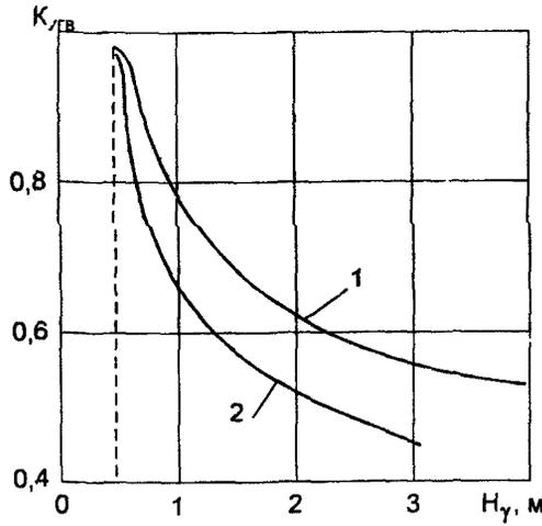
Рис. 4.1. Зависимость коэффициента  $K_{угв}$  от расстояния от низа дорожной одежды до расчетного УГВ или УГВ: 1 – супесь пылеватая и тяжелая пылеватая, суглинок; 2 – песок, супесь легкая и легкая крупная
