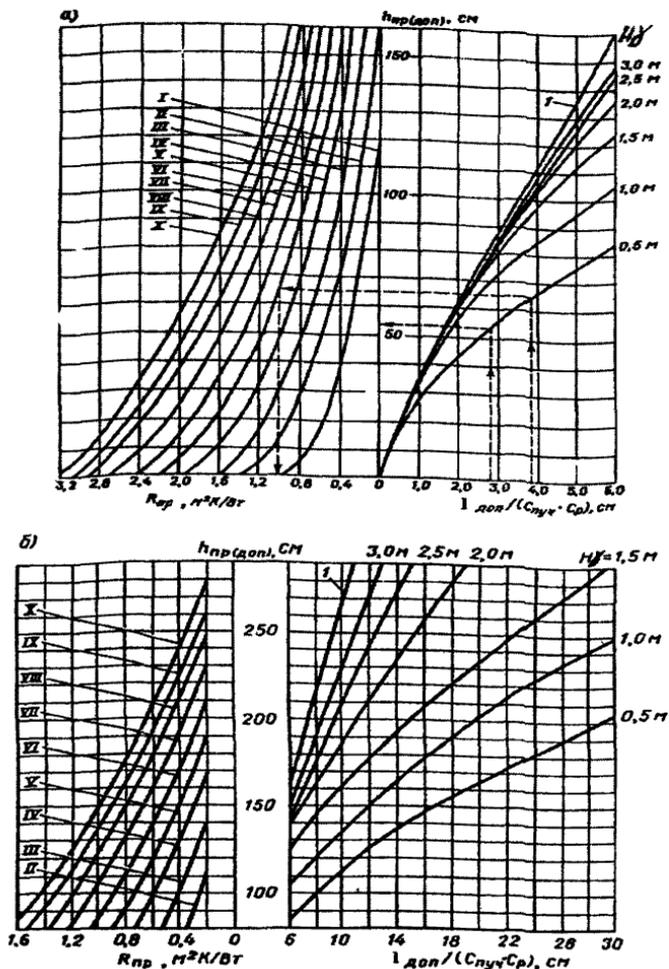
Рис.4.6. Номограмма для определения приведенного термического сопротивления дорожной одежды  $R_{пр}$ : I-X — номера изолиний на карте (см. рис.4.5); 1 — кривая расчета для 1 и 2-го типов увлажнения рабочего слоя земляного полотна;  $H$ , — глубина залегания расчетного УГВ от низа дорожной одежды, включая морозозащитный слой
