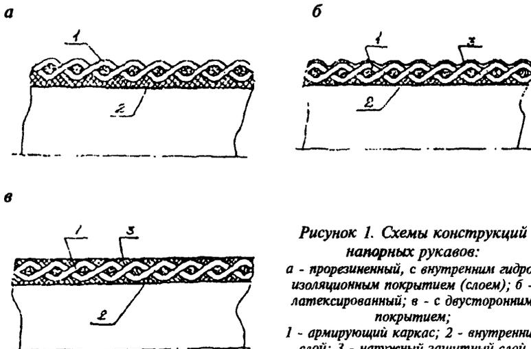
*Рисунок 1. Схемы конструкций
