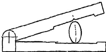
Рисунок 3. Приспособление для оценки хрупкости покрытия рукава
