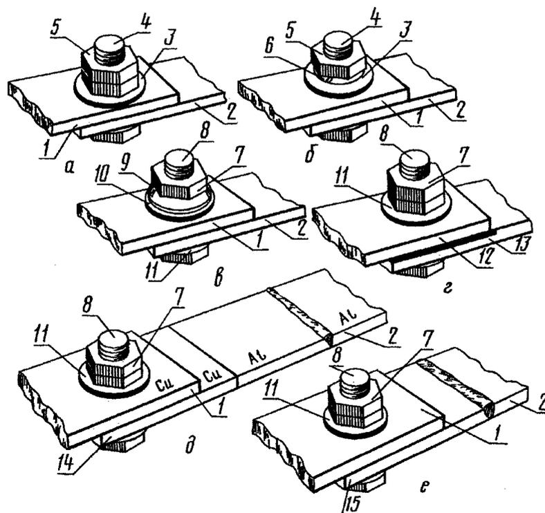
*a* — крепежом из цветного металла с контргайкой; *б* — крепежом из цветного металла с пружинной шайбой; *в* — стальным крепежом с тарельчатой пружиной; *г* — стальным крепежом с защитными металлическими покрытиями рабочих поверхностей с контргайкой (пружинной шайбой); *д* — стальным крепежом через переходную медно-алюминиевую пластину с контргайкой (пружинной шайбой); *е* — стальным крепежом через переходную пластину из твердого алюминиевого сплава с контргайкой (пружинной шайбой)
