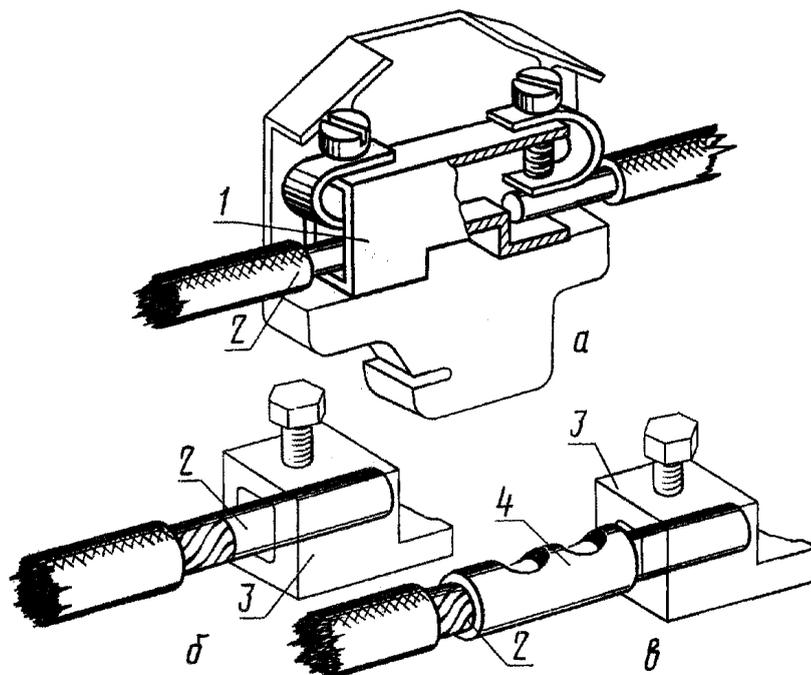
*a, б* — однопроволочная (многопроволочная, сплавленная в монолит) жила; *в* — многопроволочная жила, оконцованная кабельным наконечником
