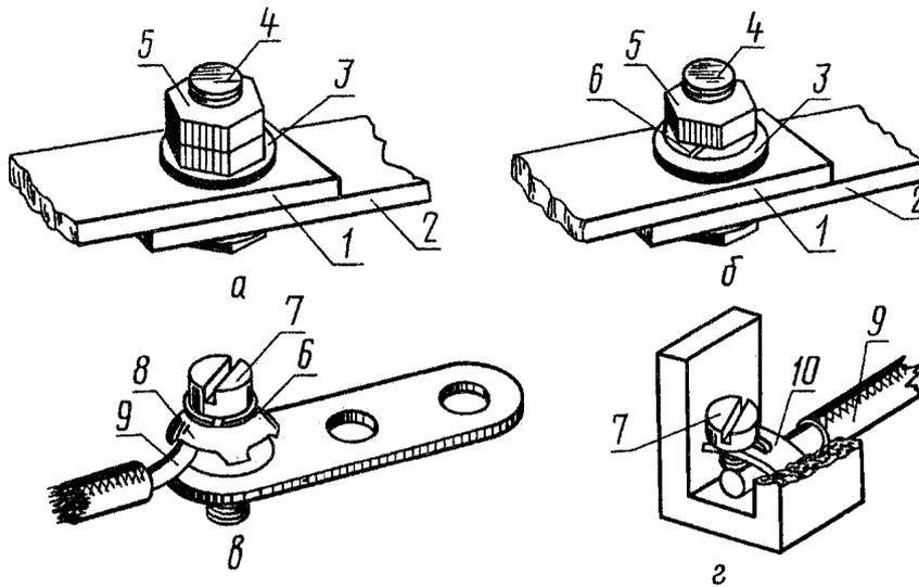
*a* — с контргайкой; *б* — с пружинной шайбой; *в* — однопроволочная (многопроволочная) жила провода (кабеля) сеч. до 10 мм<sup>2</sup> с изгибанием в кольцо; *г* — однопроволочная (многопроволочная) жила провода (кабеля) сеч. до 10 мм<sup>2</sup> без изгибания в кольцо
