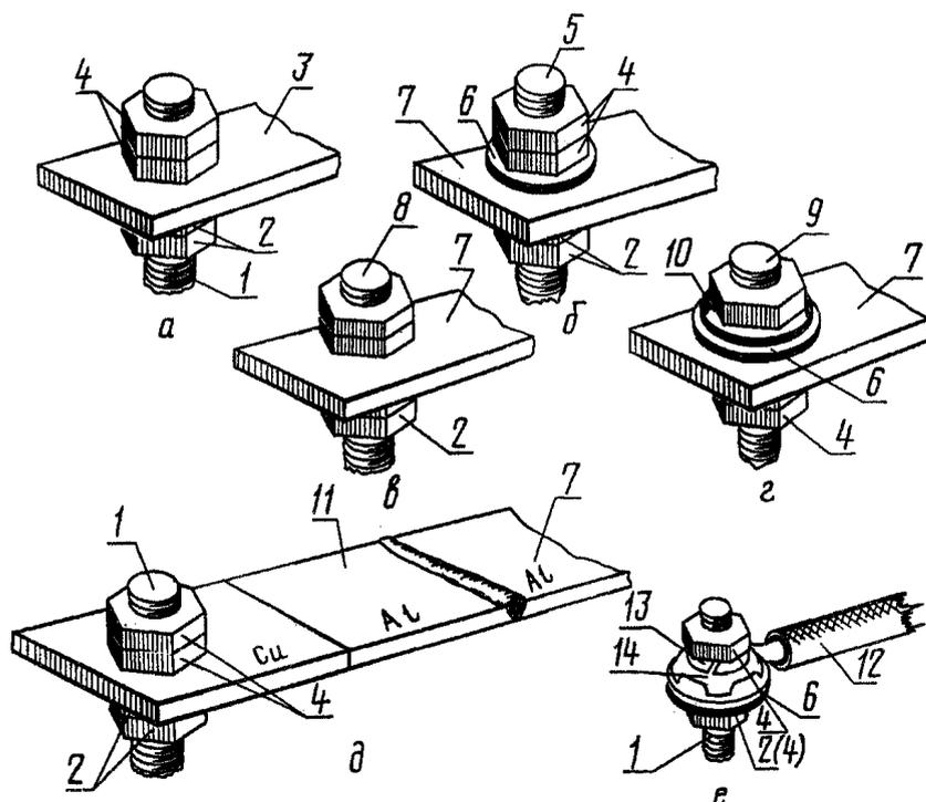
*а* — проводник из меди, твердого алюминиевого сплава или алюминия с защитным металлическим покрытием рабочей поверхности; *б, в, г* — алюминиевый проводник; *д* — алюминиевый проводник через переходную медно-алюминиевую пластину; *е* — однопроволочная (многопроволочная) жила провода кабеля сеч.  $10 \text{ мм}^2$  с изгибанием в кольцо
