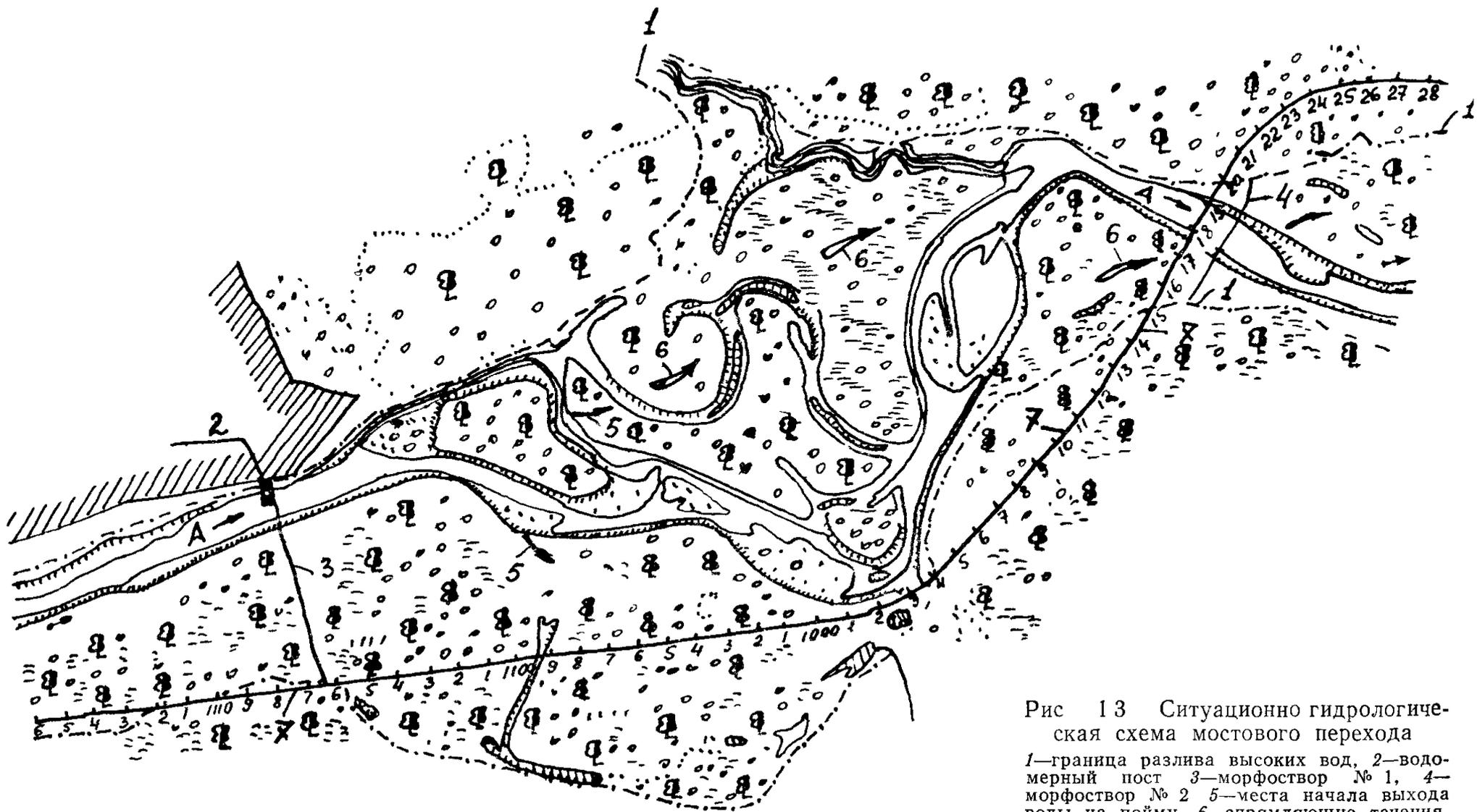
Рис 13 Ситуационно гидрологическая схема мостового перехода
