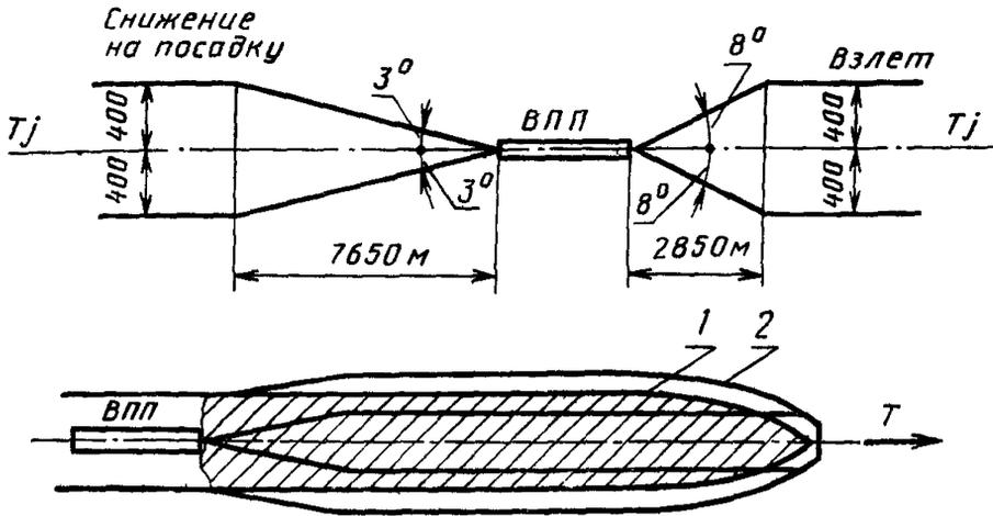
1 — контур шума, построенный для взлета самолета по идеальной прямой; 2 — то же, с учетом отклонения от идеального маршрута полета
