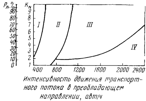
Рис. 2.1. Номограмма для оценки пропускной способности трехполосных дорог с различными проектными решениями:
