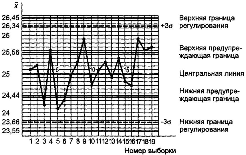
Рисунок Б.1 — Пример контрольной карты для арифметического среднего с предупреждающими границами
