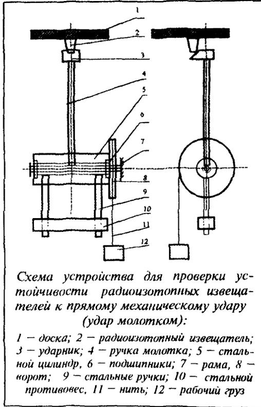
Схема устройства для проверки устойчивости радиоизотопных извещателей к прямому механическому удару (удар молотком):
