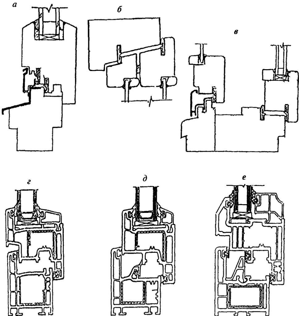
*a* — конструкция с двумя средними уплотнениями; *б* — конструкция со средним и внутренним уплотнениями; *в* — конструкция с двумя средними и внутренним уплотнениями; *г* — конструкция с наружным и внутренним уплотнениями; *д* — конструкция со средним и внутренним уплотнениями; *е* — конструкция с наружным, средним и внутренним уплотнениями
