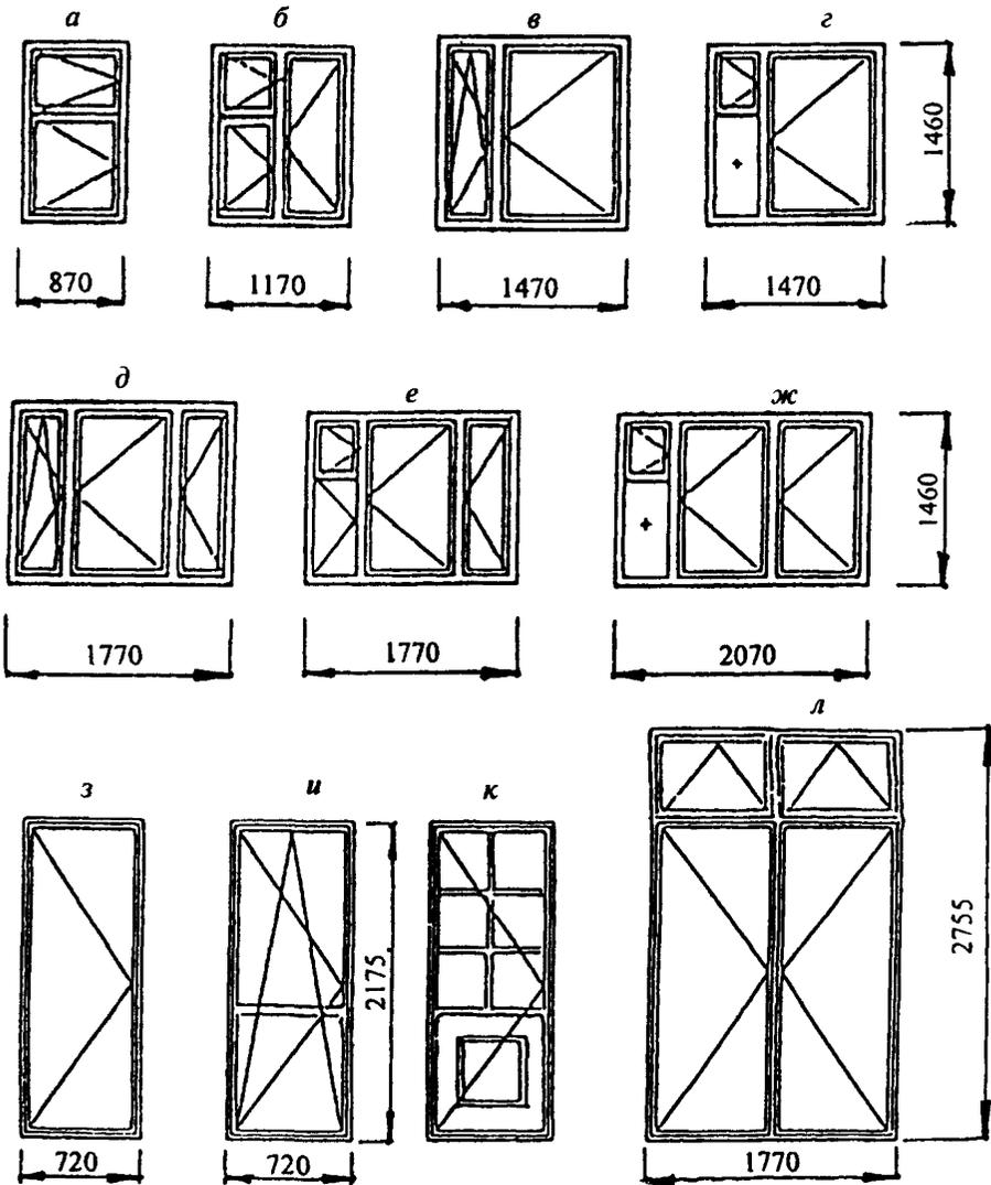
*а, б, в, г, д, е, ж* — примеры конструкций оконных блоков 15М по высоте; *з, и* — конструкция однопольных балконных дверных блоков размером 22-7; *к* — то же, по индивидуальному заказу: с горбыльковым переплетом и глухой филёнкой; *л* — примеры конструкции двупольного балконного дверного блока с двойной фрамугой для общественных зданий размером, 28-18
