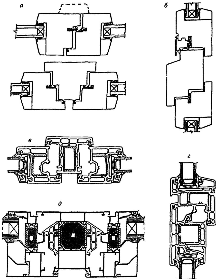
*а* — вертикальные безимпостный (штульповой) и импостный притворы деревянного оконного блока, *б* — горизонтальный импостный притвор деревянного оконного блока, *в* — импостный притвор оконного блока из ПВХ профилей, *г* — узел импостного соединения открывающейся створки и остекленной коробки, *д* — импостный притвор оконного блока из алюминиевого сплава
