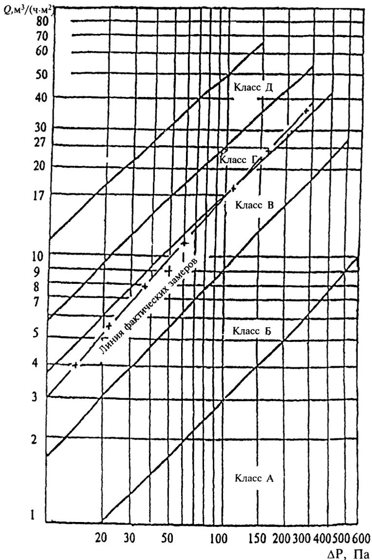
Рисунок Б.1 — Пример определения класса воздухопроницаемости
