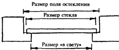
*Рисунок А.1* — Определение размеров светопрозрачного заполнения
