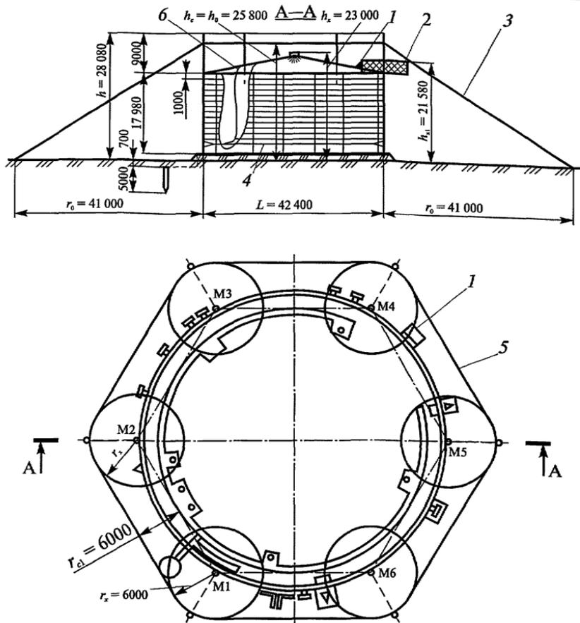
**Рис. 9.** Молниезащита металлического резервуара вместимостью 20 тыс. м<sup>3</sup> со сферической крышей и понтоном:
