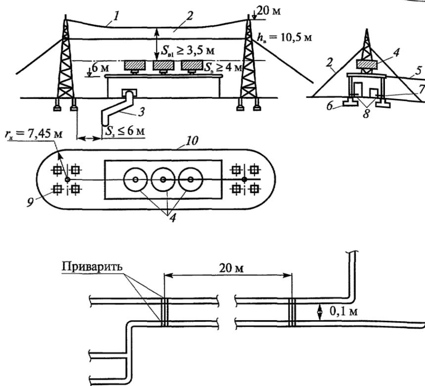
**Рис. 4.** Молниезащита здания I категории отдельно стоящим тросовым молниеотводом ( $\rho = 300 \text{ Ом}\cdot\text{м}$ ,  $S_c \leq 4 \text{ м}$ ,  $S_z \leq 6 \text{ м}$ ,  $S_{вз} \leq 3,5 \text{ м}$ ):
