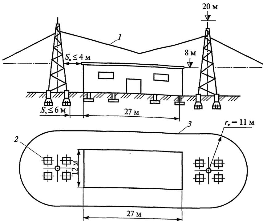
**Рис. 3.** Молниезащита здания I категории отдельно стоящим двойным стержневым молниеотводом ( $\rho = 300 \text{ Ом}\cdot\text{м}$ ,  $S_b \leq 4 \text{ м}$ ,  $S_s \leq 6 \text{ м}$ ):
