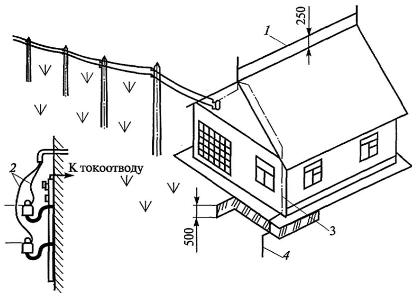
**Рис. 10.** Молниезащита сельского дома тросовым молниеотводом, установленным на крыше:
