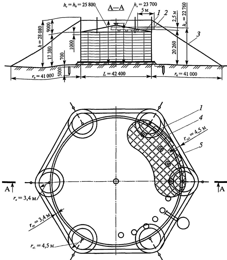
**Рис. 8.** Молниезащита металлического резервуара вместимостью 20 тыс. м<sup>3</sup> со сферической крышей:
