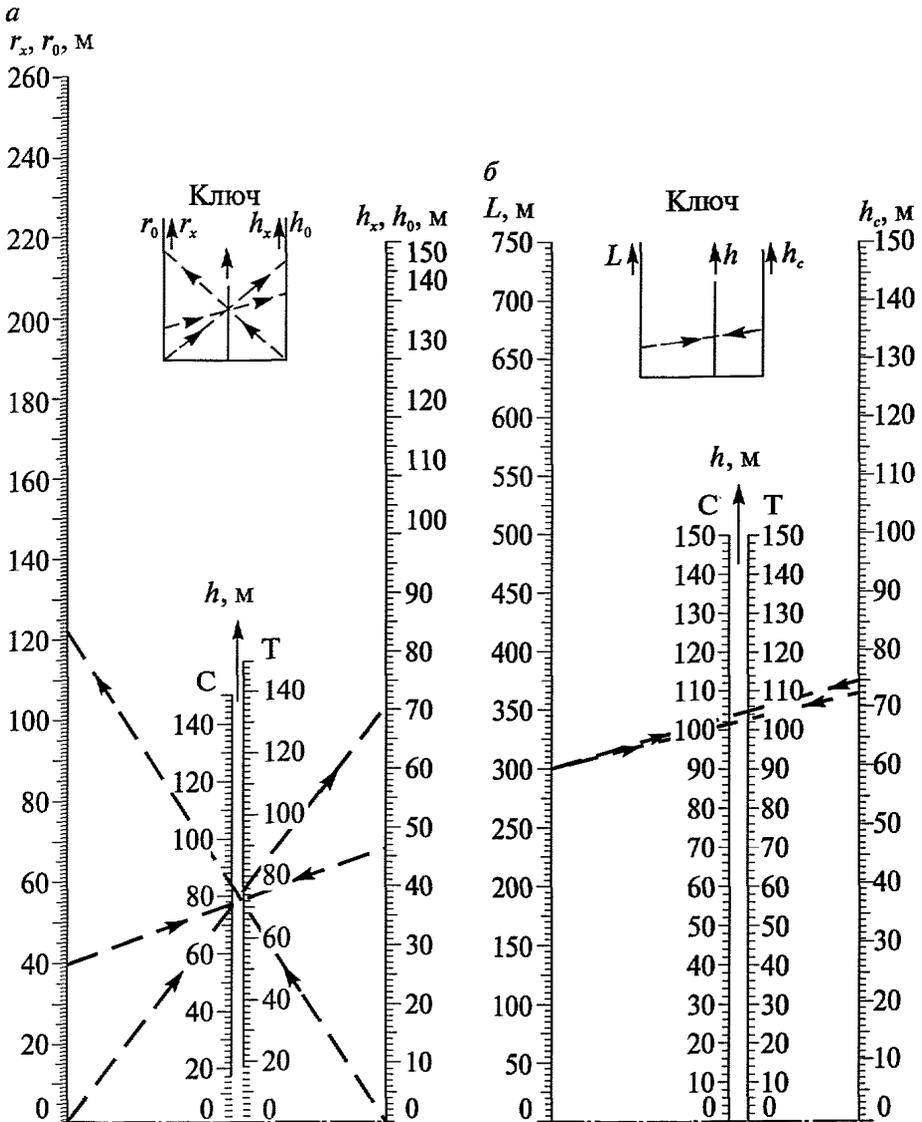
Рис. 2. Номограммы для определения высоты молниеотводов в зоне Б:
