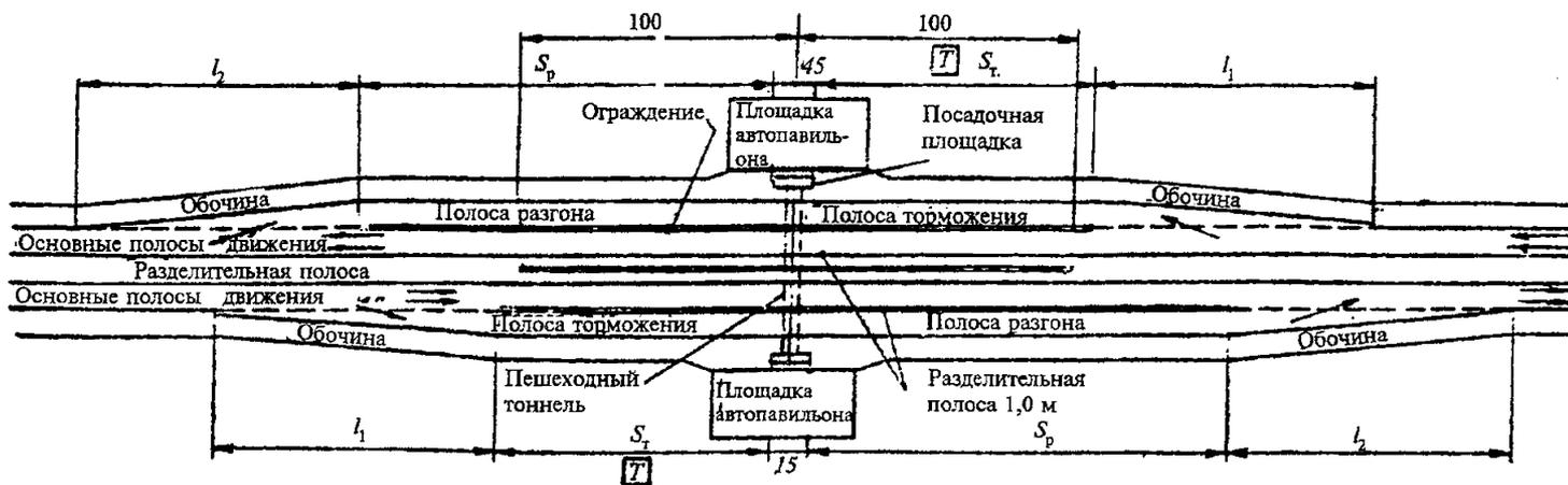
Рис. 4. Пример (схема) размещения автобусных остановок на дороге I категории (то же, II категории).
