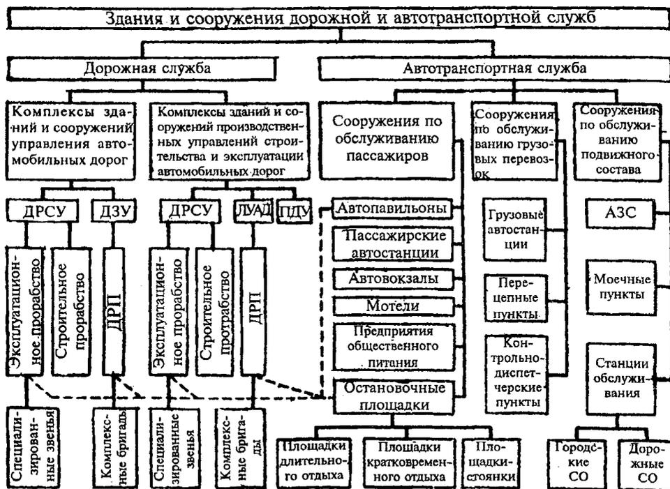
**2.9.** Линейное управление автомобильных дорог (ЛУАД) осуществляет ремонт и содержание всех автомобильных дорог общего пользования (кроме дорог общегосударственного значения) в пределах одного административного района, области, края, АССР. В состав комплекса зданий и сооружений ЛУАД входят, как правило, те же сооружения, что и в комплекс ДЭУ (п. 2.8).
