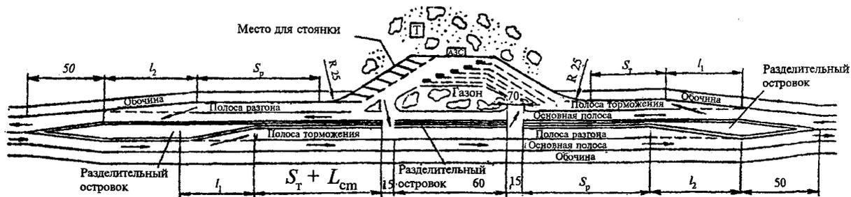
Рис. 7. Пример (схема) размещение автозаправочной станции на дороге II категории при интенсивности до 4000 автомобилей в сутки и на дороге III категории.
