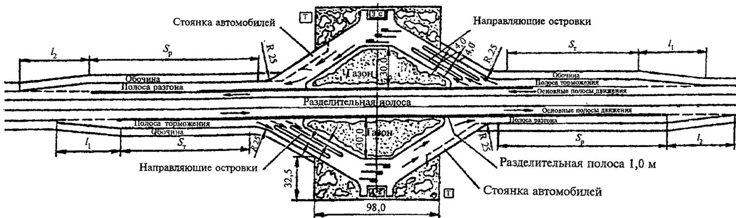
Рис. 5. Пример (схема) размещения автозаправочной станции на дороге I категории.
