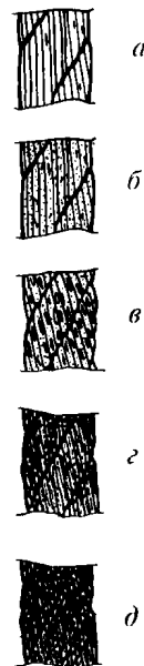
Рис. 5. Поверхностная коррозия проволок каната крестовой свивки: a — начальное окисление поверхности; б — общее окисление поверхности; в — заметное окисление; z — сильное окисление; д — интенсивная коррозия
