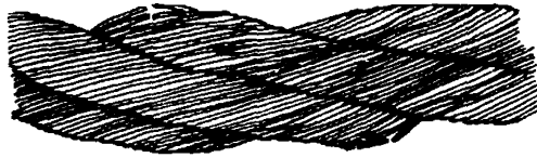
Рис. 1. Обрывы и смещения проволок каната крестовой свивки
