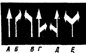
1.18. Обозначение направлений движения по полосам (п. 2.4.6).
