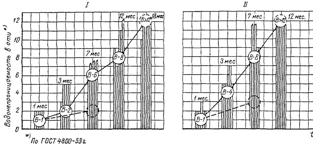
**Зависимости водонепроницаемости бетона от возраста**
