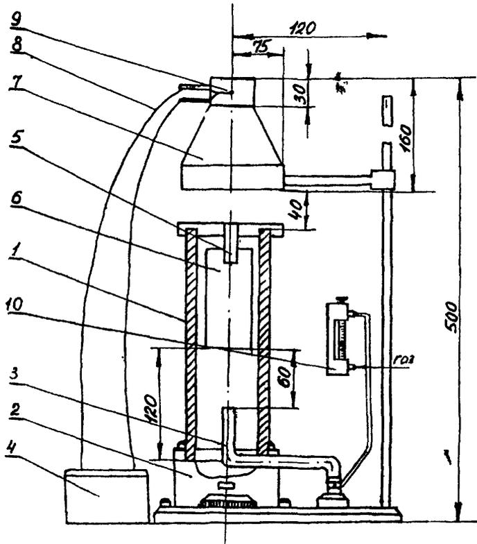
Рис. 1. Установка для определения огнезащитной эффективности ОЗСВ:
