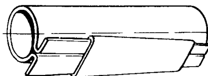
Рис 9 22 Манжета с клиновой обоймой для соединения тонкостенных труб
