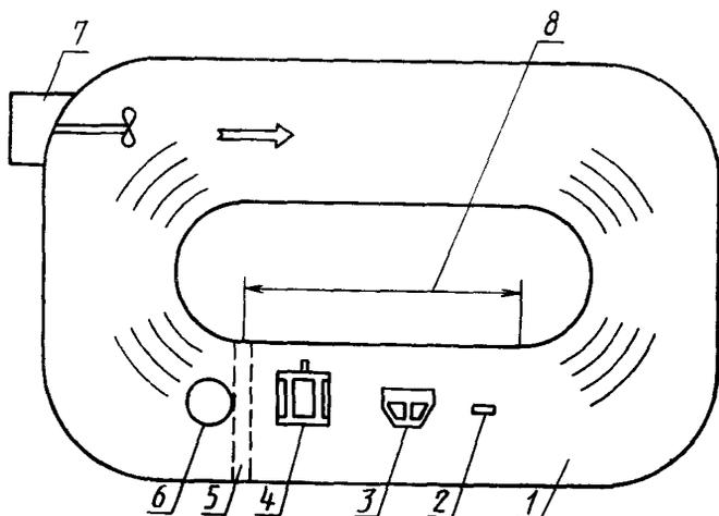
1 — аэродинамическая труба; 2 — измеритель температуры; 3 — место установки испытуемого извещателя; 4 — контрольная ионизационная камера; 5 — место установки нагревательного элемента; 6 — место ввода продуктов горения (аэрозоля); 7 — вентилятор; 8 — измерительный участок; стрелками показано направление движения контролируемой среды
