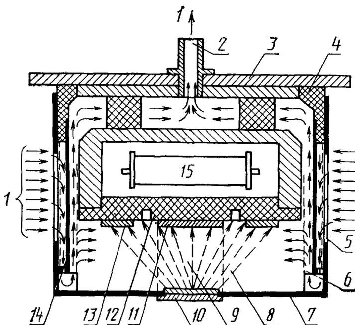
1 — контролируемая среда; 2 — штуцер всасывания контролируемой среды; 3 — основание конструкции; 4 — изолирующее кольцо; 5 — внешняя сетка; 6 — внутренняя сетка; 7 — внешний электрод; 8 — излучение; 9 — измерительный объем; 10 — источник ионизирующего излучения; 11 — измерительный электрод; 12 — изоляционный материал; 13 — охранное кольцо; 14 — ветрозащита; 15 — измерительный резистор; стрелками показано направление движения контролируемой среды при пробоотборе
