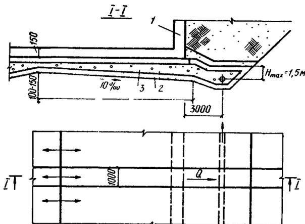
Черт. 16. Расчетная схема пластового дренажа
