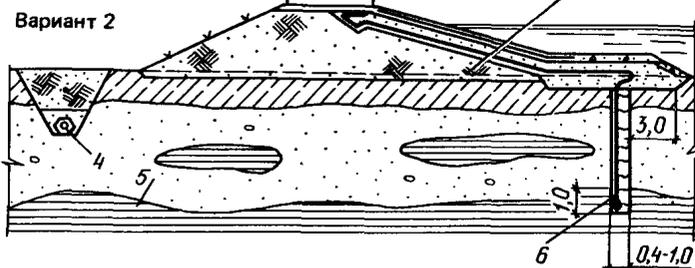
Черт. 10. Грунтовая диафрагма „стена в грунте” в сочетании с полиэтиленовой пленкой
