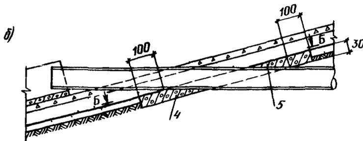
Черт. 7. Экран из полиэтиленовой пленки однослойный. Узлы
