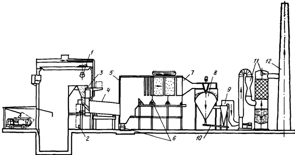
Черт. 1. Агрегат сжигания твердых, пастообразных и жидких токсичных промышленных отходов (фирма „Фон-Ролл” — Швейцария)
