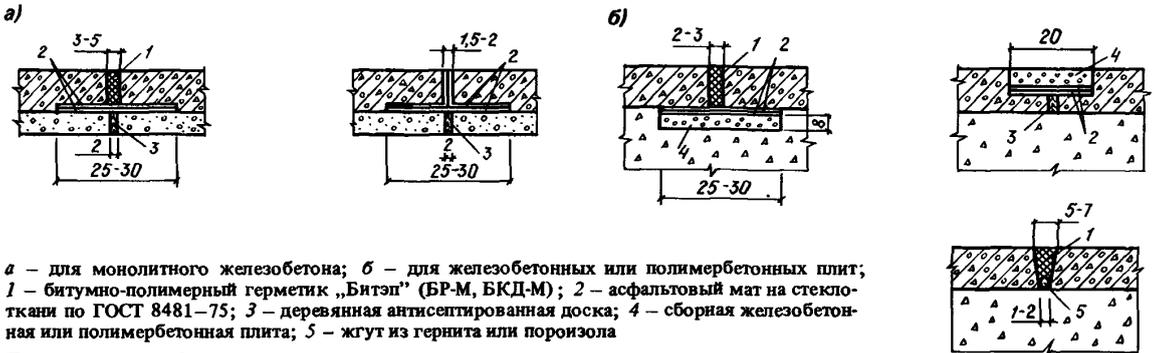
*а* – для монолитного железобетона; *б* – для железобетонных или полимербетонных плит; 1 – битумно-полимерный герметик „Битэп“ (БР-М, БКД-М); 2 – асфальтовый мат на стеклоткани по ГОСТ 8481–75; 3 – деревянная антисептированная доска; 4 – сборная железобетонная или полимербетонная плита; 5 – жгут из гернита или поризола
