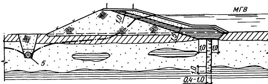
Черт. 9. Вертикальная глиняная диафрагма „стена в грунте” (размеры в метрах)
