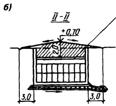
Грунт, уплотненный катками массой 5 т за 5 проходов и обработанный битумом и цементом
