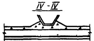
Черт. 6. Экран из полиэтиленовой пленки однослойный. Разрезы II-II, III-III, IV-IV
