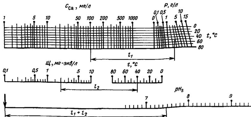
Рис. 2. Номограмма для определения концентрации свободной двуокиси углерода в природной воде (или рН)
