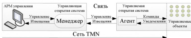
Рисунок 5. Схема взаимодействия между «менеджером», «агентом» и управляемыми объектами.
