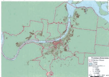
Рисунок Г1. Результаты расчетов среднегодовых концентраций азота диоксида от стационарных источников выбросов и автотранспорта на основе сводной базы данных по поселению (расчетная сетка 400 м x 400 м)
