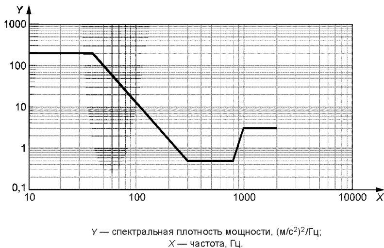
Рисунок 8 — Спектральная плотность мощности ускорения в зависимости от частоты
