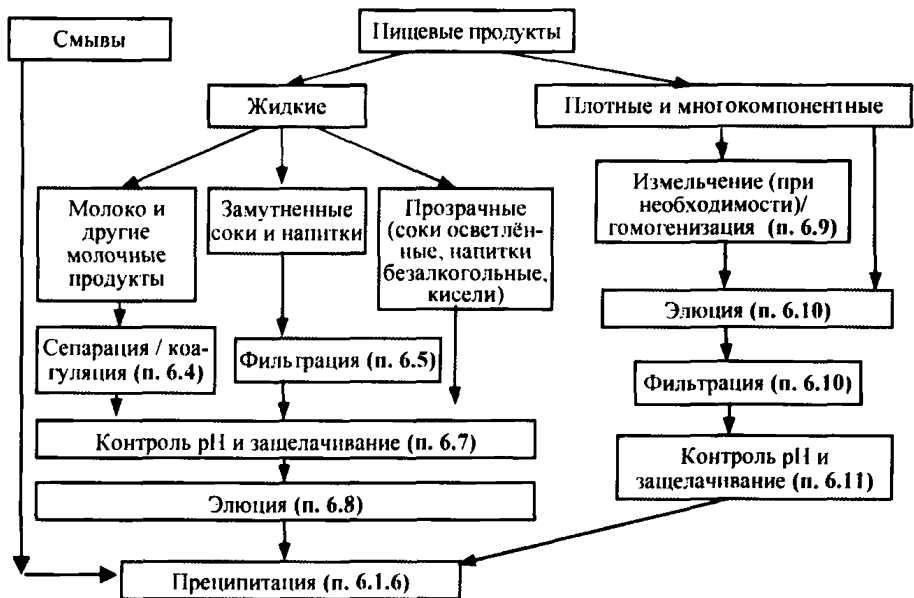
Рис. 1. Алгоритм получения вирусосодержащих водных концентратов из образцов пищевых продуктов и смывов для исследований с применением МАНК
