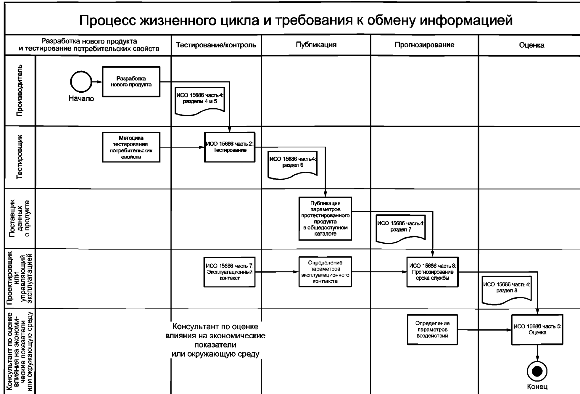
Рисунок 1 — Требования к обмену, подробно описанные в настоящем стандарте, и их связь с серией стандартов ИСО 15686
