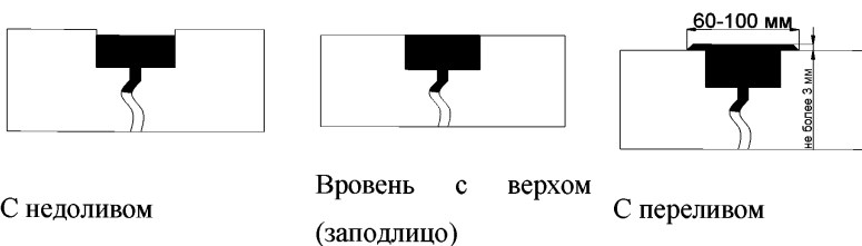
Рис. 10.3 – Варианты заливки трещин
