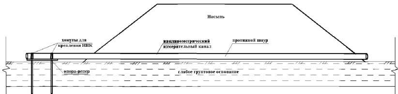
Рисунок 15 - Оборудование измерительного канала
