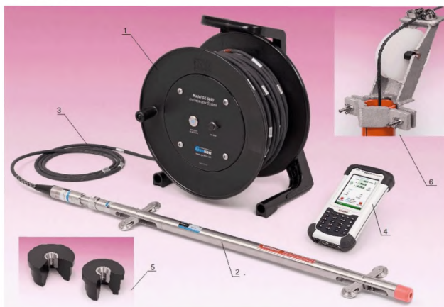
Рисунок 5 - Портативный инклинометрический измерительный комплект
