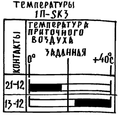
РАБОТЫ РЕГУЛЯТОРА ТЕМПЕРАТУРЫ 1П-СК3
