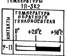
РАБОТЫ ДАТЧИКА-РЕЛЕ ТЕМПЕРАТУРЫ 1П-СК2
