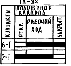
ДИАГРАММА РАБОТЫ КОНЕЧНЫХ ВЫКЛЮЧАТЕЛЕЙ ИСПОЛНИТЕЛЬНОГО МЕХАНИЗМА 1П-У2
