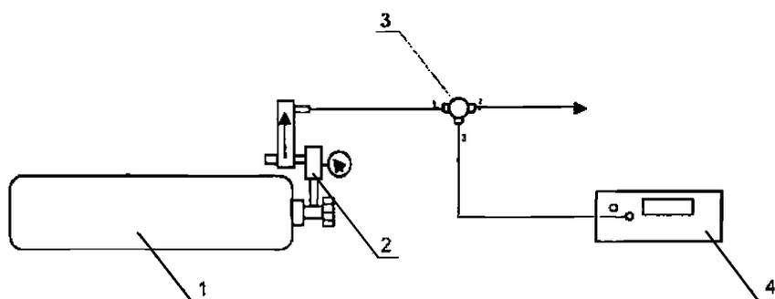
Рисунок Б.2 – Схема газовых соединений при определении основной относительной погрешности по каналу расхода устройств для отбора пробы Aerotest Simultan HP или Aerotest Alpha
