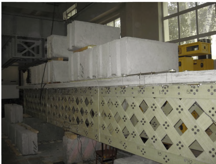
Рисунок В.2 – Испытание опытного пролетного строения
