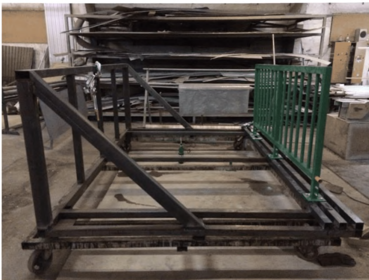
Рисунок Г.1– Площадка для испытания перильных ограждений
