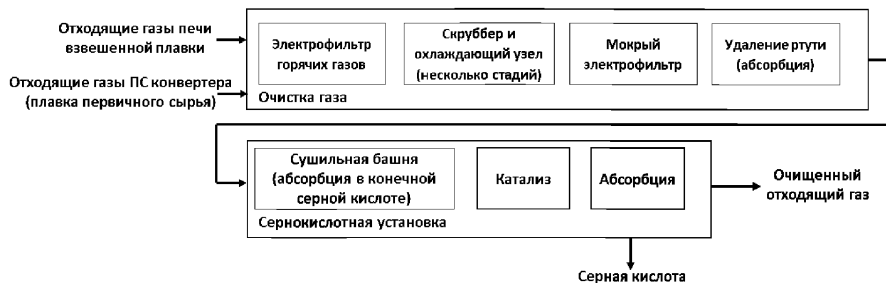
Рисунок А.169 – Типичная схема газоочистки для сернокислотной установки
