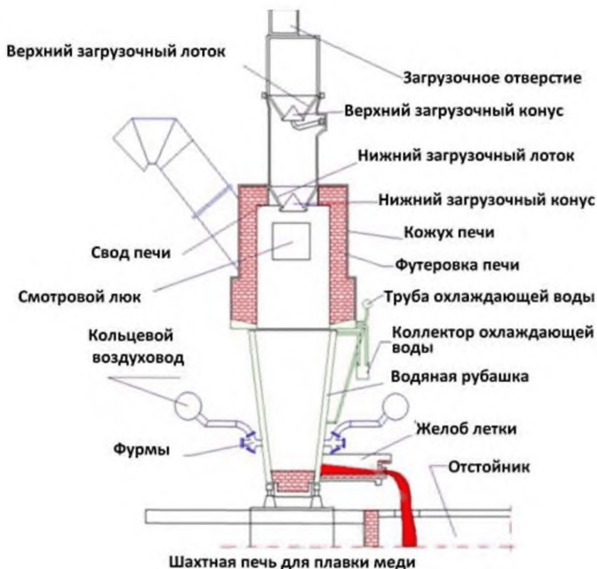
Рисунок А.3 – Шахтная печь для плавки первичной меди
