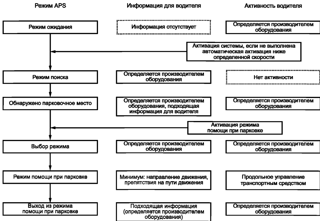
Рисунок 3 — Диаграмма режимов работы APS типа 1
