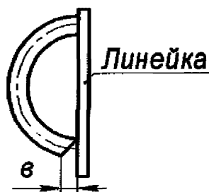
Рисунок 6.2. Схема замера плоскостности торцов отвода 180°.
