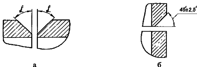
Рисунок 6.5. Подготовка кромок в зависимости от направления оси трубного элемента:
