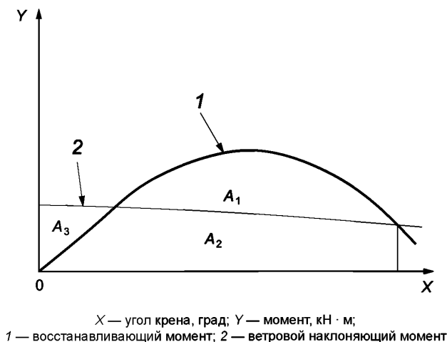
Рисунок 2 — Требование к остойчивости в неповрежденном состоянии
