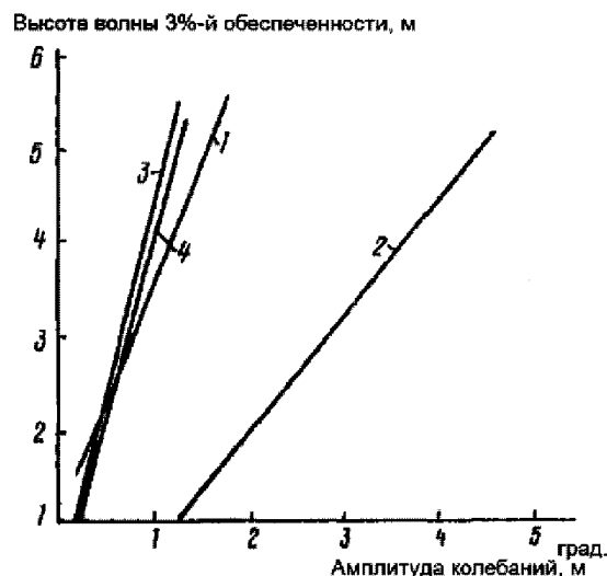
Рис. 7.3-1 Амплитуды качки на нерегулярном волнении 3%-й обеспеченности ТУС SULEYMAN VEZIROV [2]: 1, 2 — килевая ( \psi ) и бортовая ( \theta ) качка; 3, 4 — горизонтальная ( a_x ) и вертикальная ( a_z ) качка
