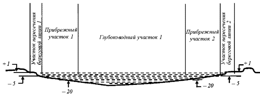
Рис. 10.1-1 Участки трассы морского трубопровода [3]
