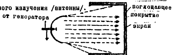
Рис.2. Экранирующая защита от излучений остронаправленной антенны.
