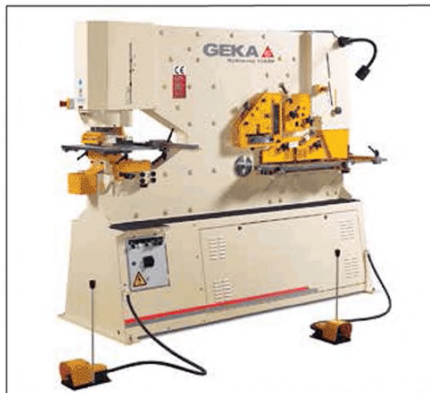
Гидравлические пресс-ножницы GEKA (Hydracrop, Minicrop...)
