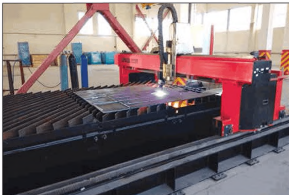
Машины плазменной (газовой) резки листа. Собственное производство в Подольске
