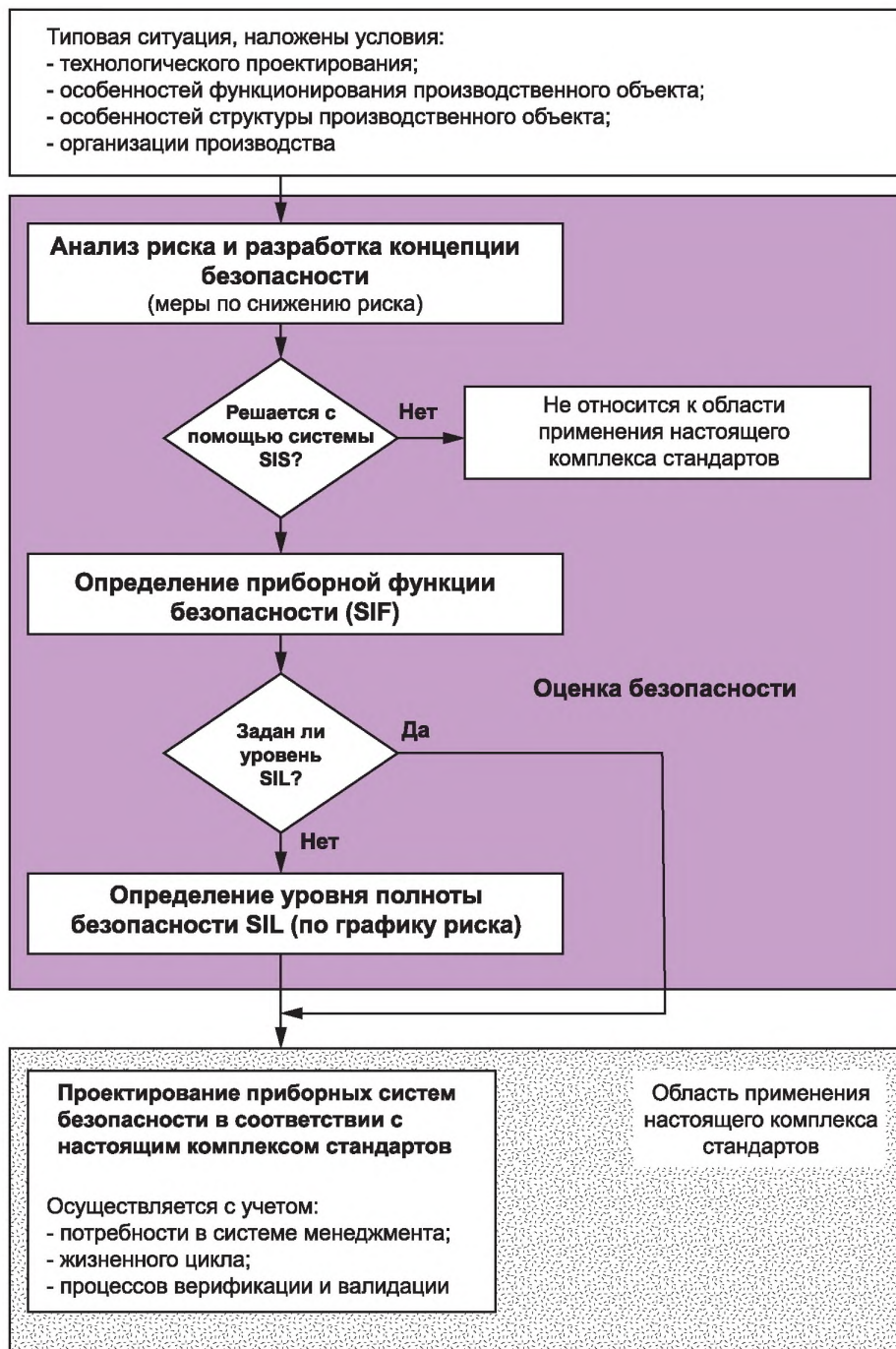
Рисунок 1 — Процедура встраивания технологии управления производственными процессами в общую концепцию безопасности
