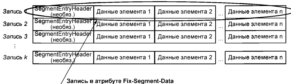
Рисунок С.4 — Запись (массив элементов в fixed-segment-data)
