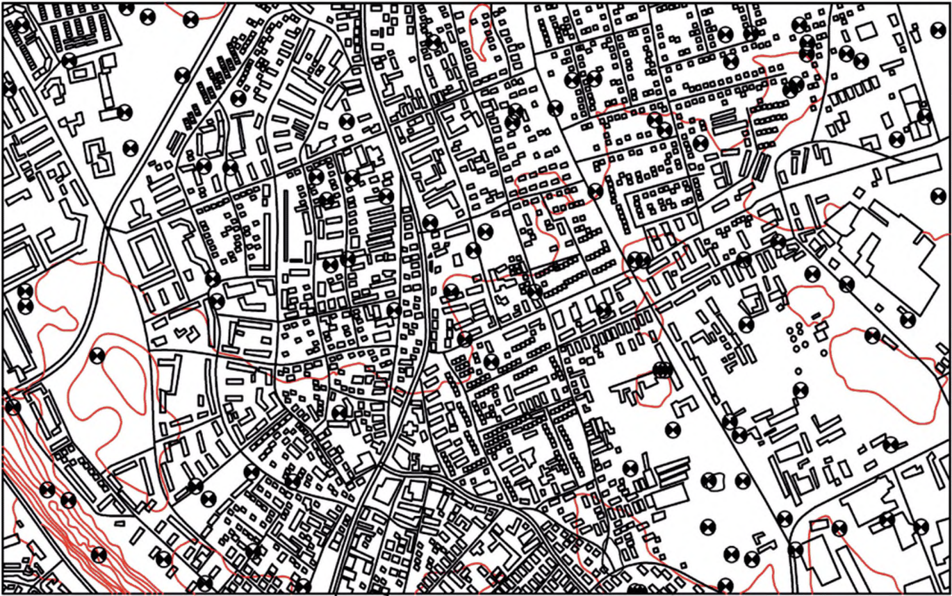
Рисунок А.2 — Часть тестового сценария «TestCity» с 400 приемниками звука
