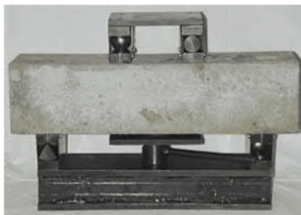
Рисунок бб – Небазовая схема испытания бетона на прочность на растяжение при изгибе (плоский контакт)
