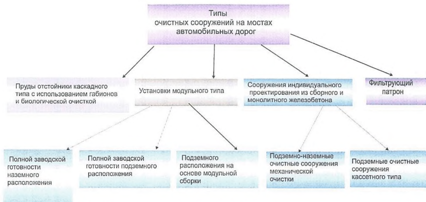
Рисунок В.1 – Типы очистных сооружений на мостах
