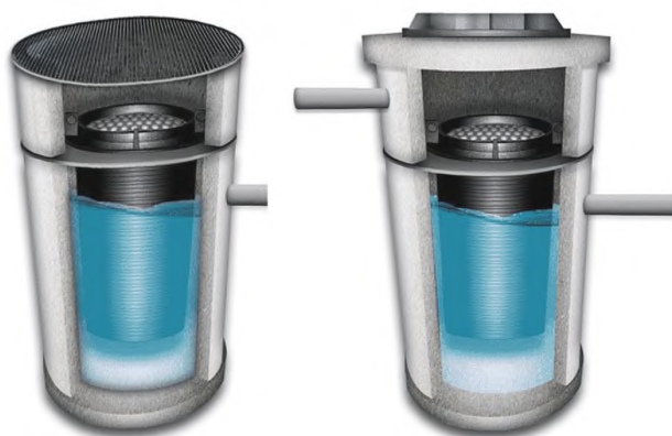
Рисунок В.8 – Типовая схема фильтрующего патрона
