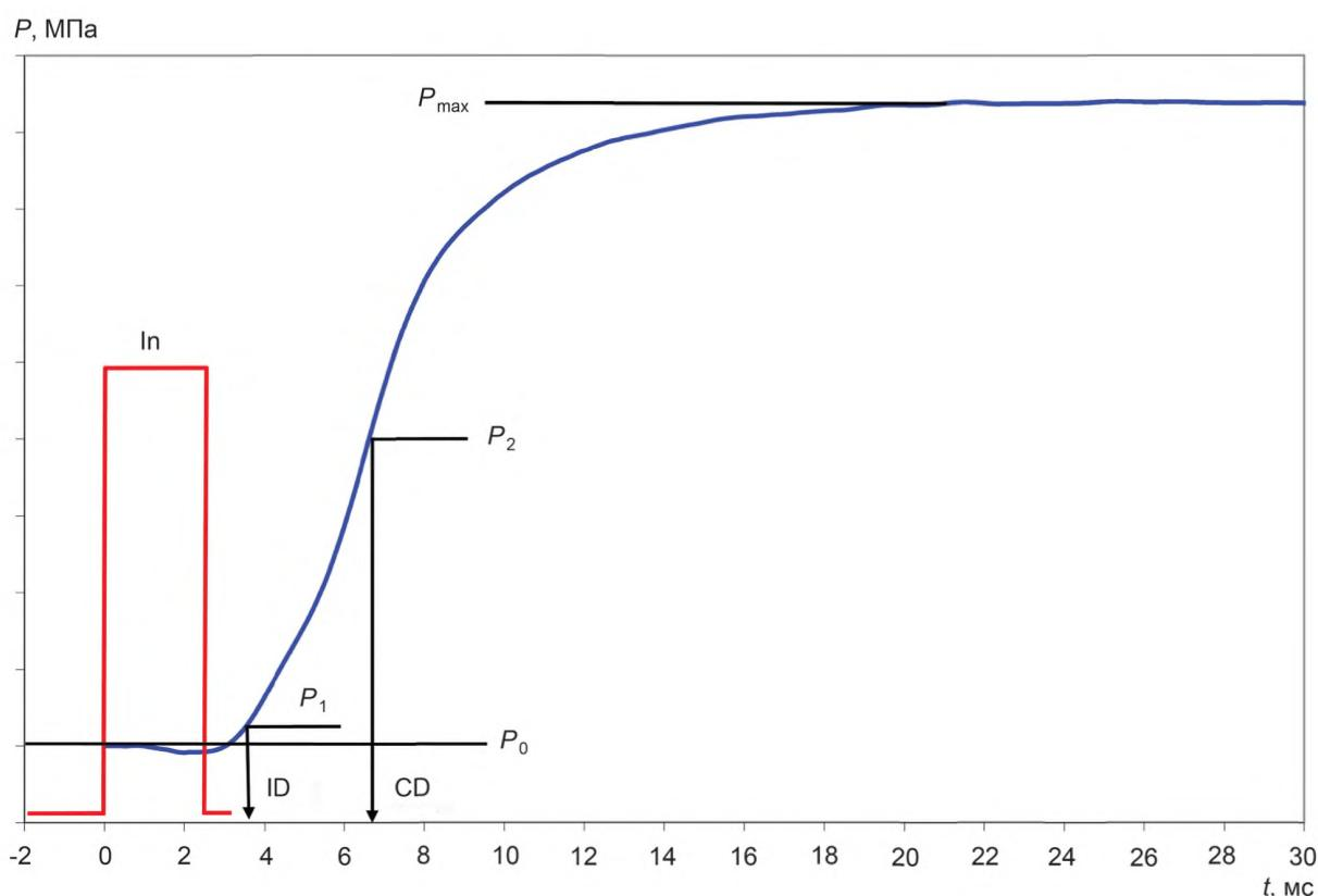
$P_0$  — начальное давление в камере;  $P_1 = (P_0 + 0,02)$  МПа (давление обнаружения ID);  $P_2 = (P_0 + P_{\max})/2$  (давление обнаружения CD);  $P_{\max}$  — максимальное давление в камере сгорания; In — сигнал открытия форсунки; ID — время задержки воспламенения; CD — время задержки сжигания;  $t$  — время, мс
